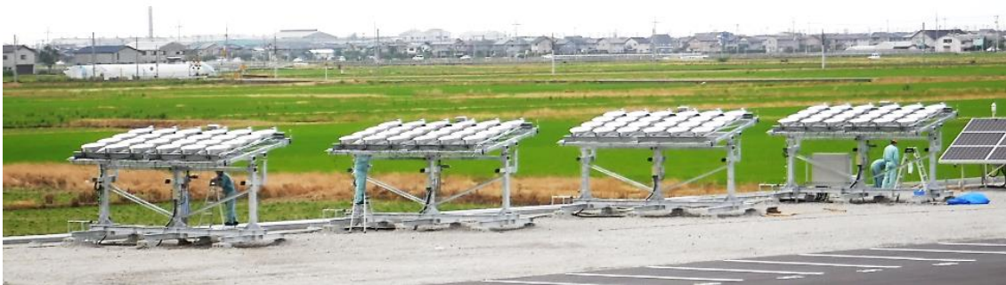
図：実証試験を開始する追尾集光型太陽エネルギー回収システム
